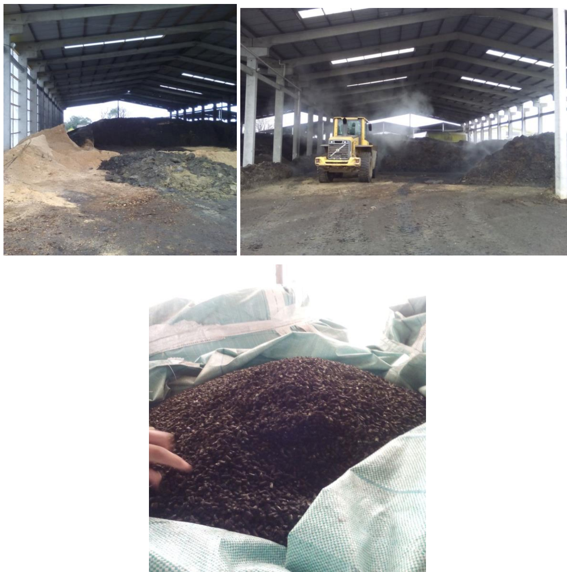
Figura 5: Vista do processo de compostagem utilizando Flotado Industrial.
